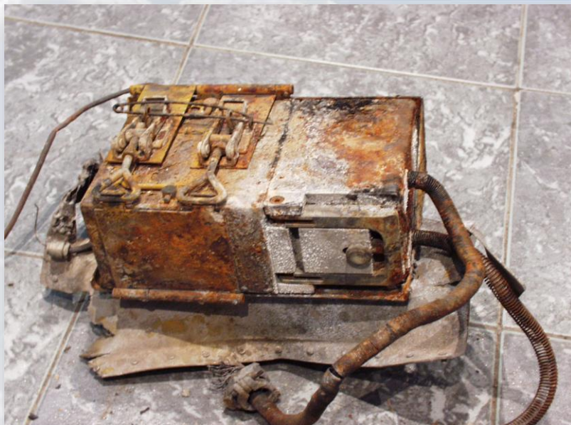
Kaseta rejestratora S2-3 po awarii samolotu PZL-130TC-I Orlik
