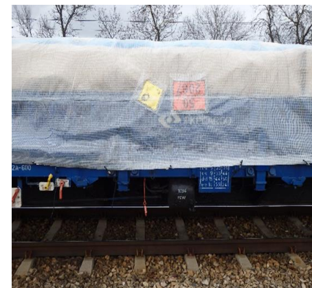
ZDJĘCIE NR 3. NIEPRAWIDŁOWOŚCI DOTYCZĄCE DUŻEJ NALEPKI OSTRZEGAWCZEJ I TABLICY BARWY POMARAŃCZOWEJ
