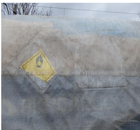
ZDJĘCIE NR 4. BRAK TABLICY BARWY POMARAŃCZOWEJ, USZKODZONA DUŻA NALEPKA OSTRZEGAWCZA
