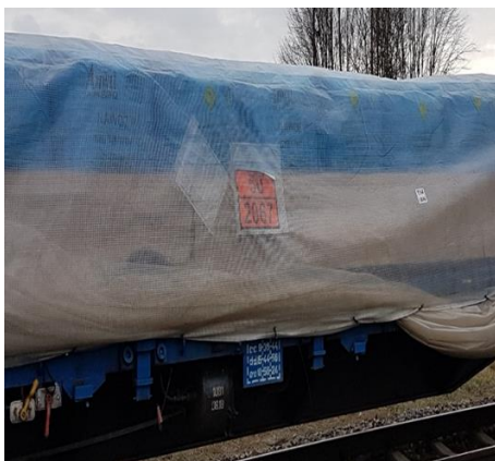
ZDJĘCIE NR 4. BRAK TABLICY BARWY POMARAŃCZOWEJ, USZKODZONA DUŻA NALEPKA OSTRZEGAWCZA
