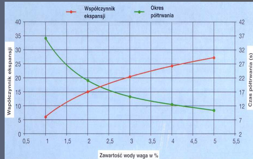
Rys. 5. Zależność ekspansji asfaltu i okresu jej półtrwania od ilości wody [4]
