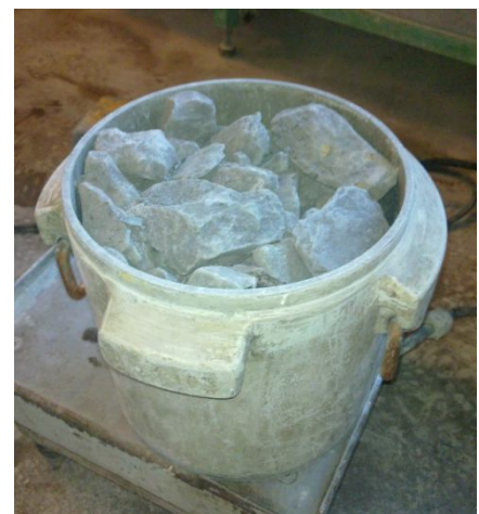
Rys. 3: Kruszywo w naczyniu badawczym
