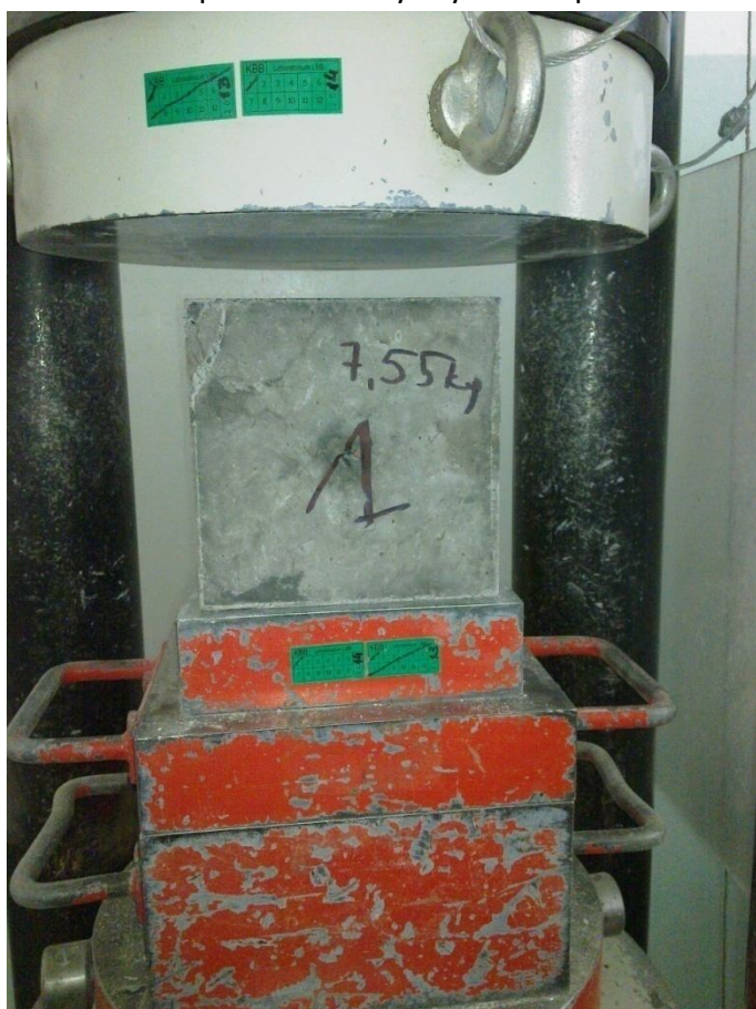
Rys. 9: Próbką nr 1 podczas badania w prasie wytrzymałościowej.
