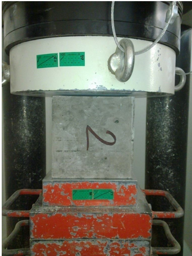
Rys. 10: Próbkę nr 2 podczas badania w prasie wytrzymałościowej.
