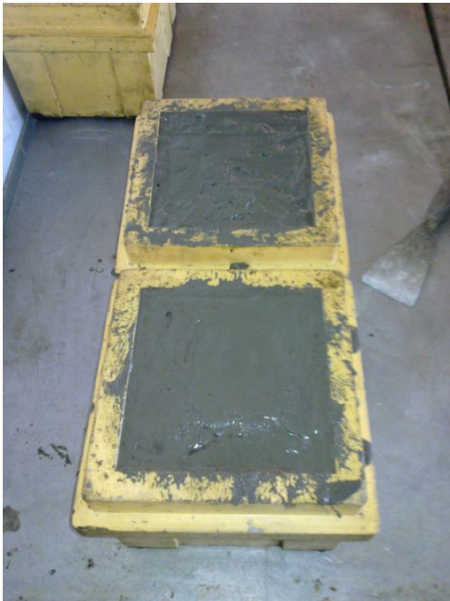
Rys. 7: Mieszanka umieszczona w foremkach normowych.
