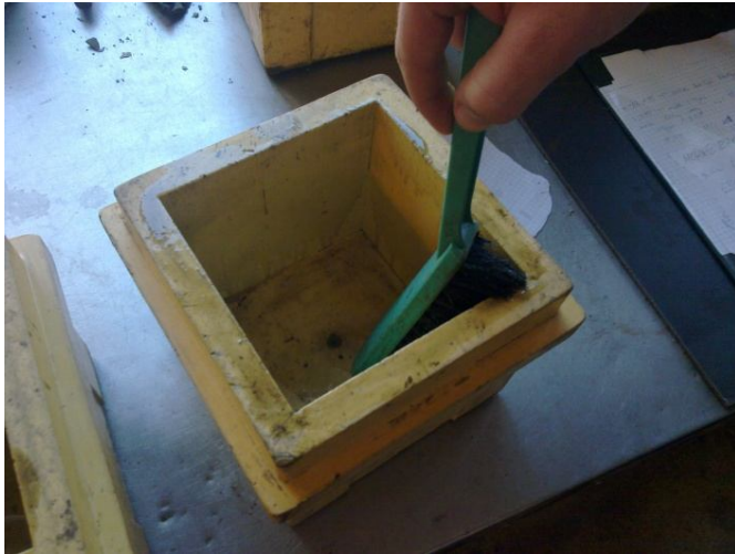
Rys. 6: Przygotowanie foremek normowych do wykonania próbek.
