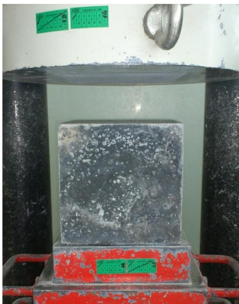
Rysunek 6 – Badanie wytrzymałości betonu
