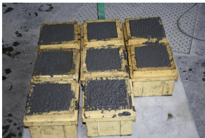
Rysunek 3 – Próbkę betonowe
