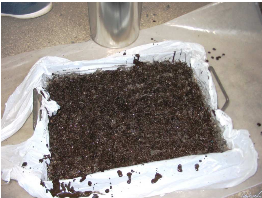
ZDJĘCIE 7 - PRÓBKKA ZALANA EMULSJĄ ASFALTOWĄ
