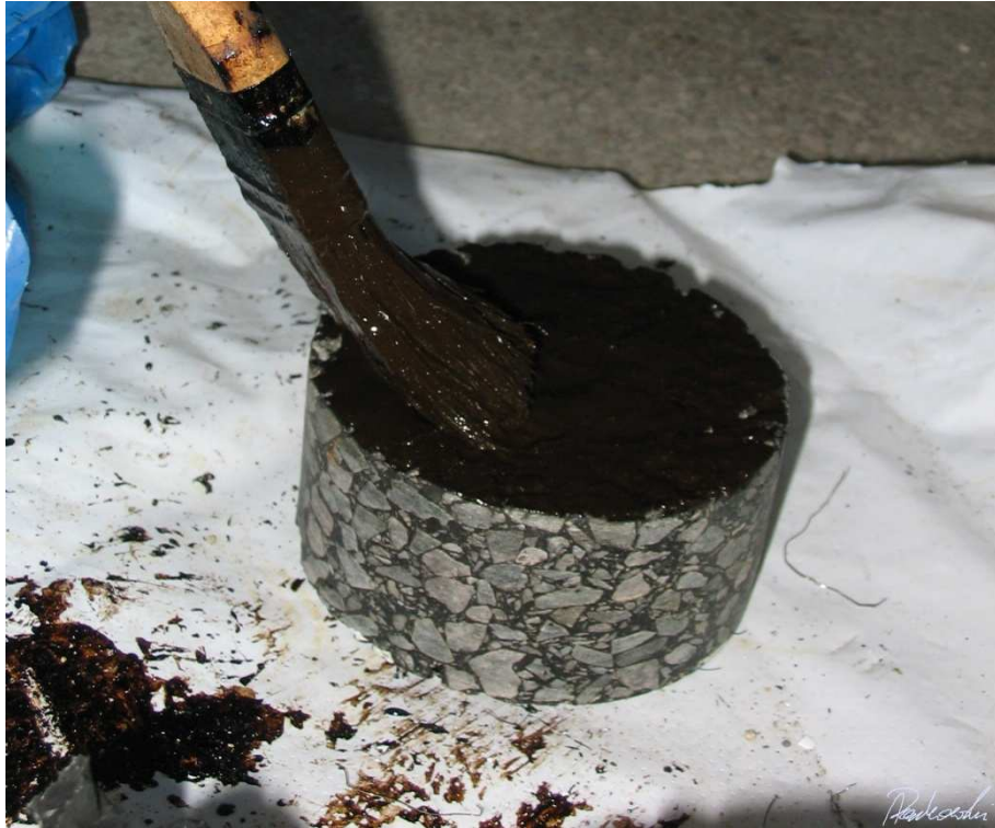
ZDJĘCIE 8 - PRÓBKĄ MARSHALLA POKRYTĄ EMULSIJĄ ASFALTOWĄ
