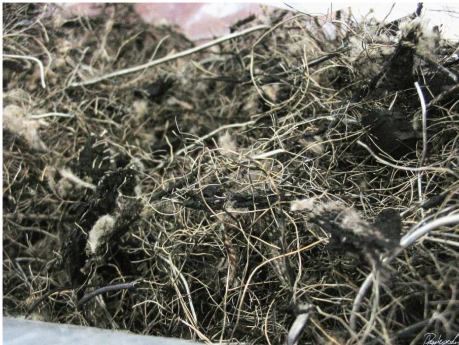
ZDJĘCIE 1 - DRUT STALOWY Z RECYKLINGU OPON
