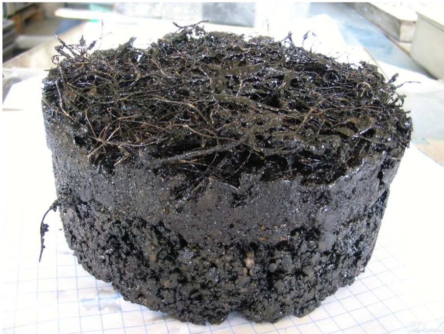
ZDJĘCIE 11 - POŁĄCZENIE MMA Z MATĄ WYPEŁNIONĄ MIESZANKĄ MINERALNO-EMULSYJNĄ
