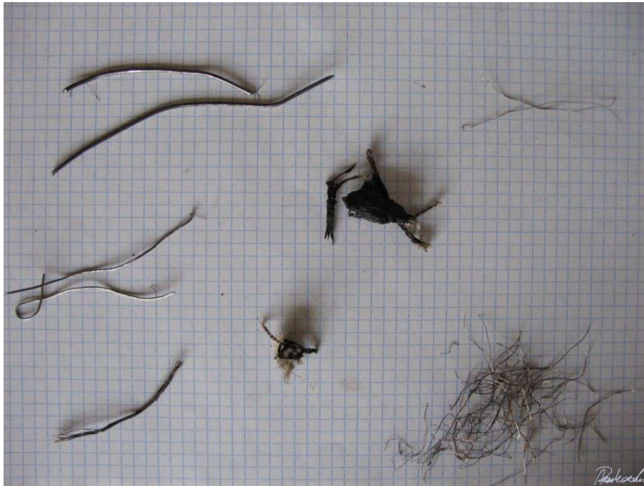
ZDJĘCIE 2 - SPECYFIKACJA PRÓBKII DRUTU STALOWEGO Z RECYKLINGU
