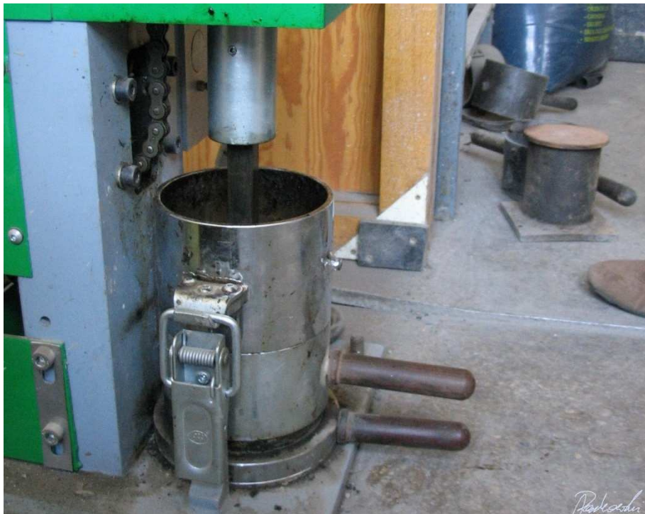
ZDJĘCIE 9 - ZAGĘSZCZANIE W UBIJAKU MARSHALLA
