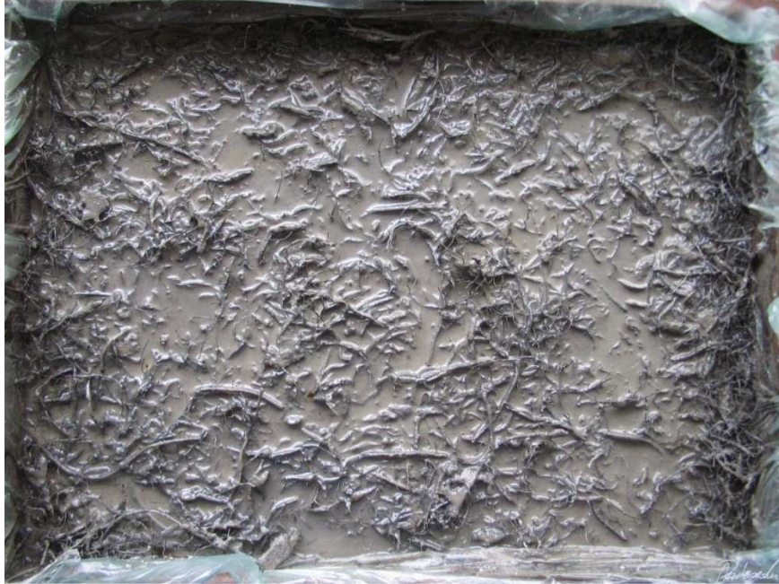
ZDJĘCIE 14 - STALOMECH WYPEŁNIONY ZAPRAWĄ CEMENTOWĄ
